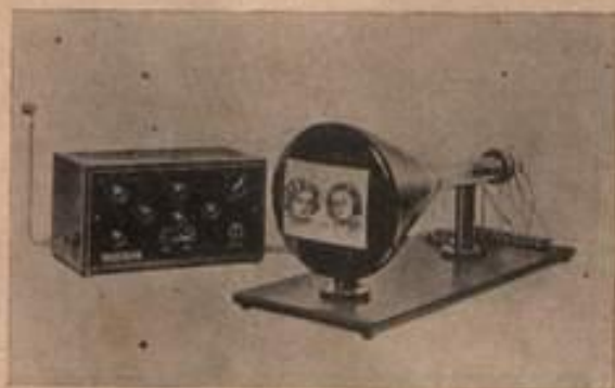
Abb. 4. Spezialfernseh-Superhetempfänger und Kathodenstrahloszillograph der Radioaktiengesellschaft D. S. Loewe.
