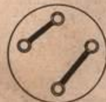
Abb. 2. Kurzschlußsockel für Gleichstromspeisung.
