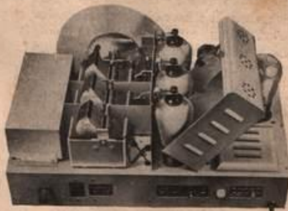
Abb. 7. Stahlchassis mit gekapseltem Kondensatorenblock.
